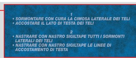
INDEX ha personalizzato la finitura superficiale superiore di **FONOSTOPDuo**, sovrastampando alcune importanti avvertenze di posa al fine di agevolare l'operatore nelle fasi di realizzazione del pavimento galleggiante per l'isolamento acustico da calpestio
